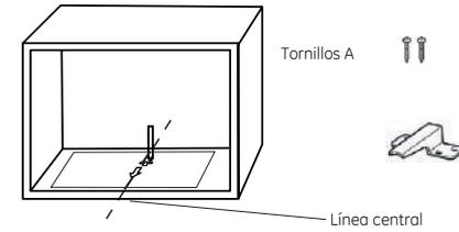
3. Retire el esquema del panel inferior del gabinete y sujete la abrazadera y el tornillo A.
