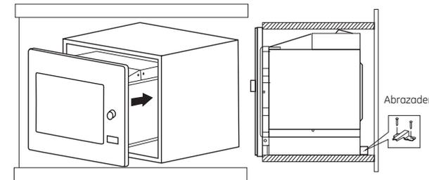
5. Abra la puerta, sujete el horno al gabinete con tornillo A, en los orificios de instalación.
